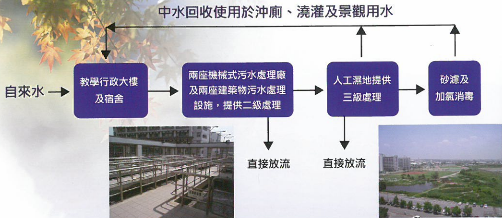
圖15 本校污水處理及再生水(中水)回收利用示意圖
