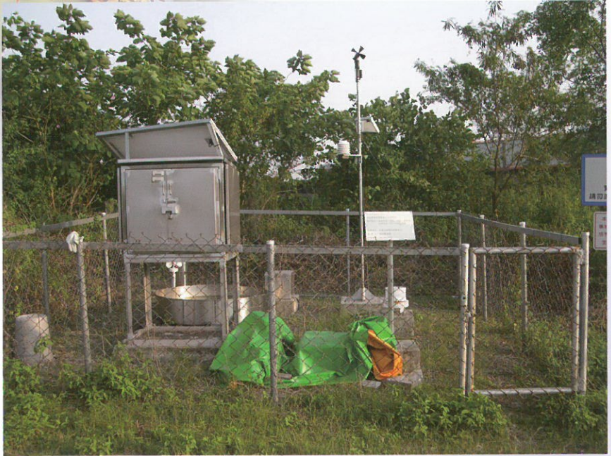
圖13 氣象資料監測站：提供研究所需資料，必要的電源來自太陽能。
