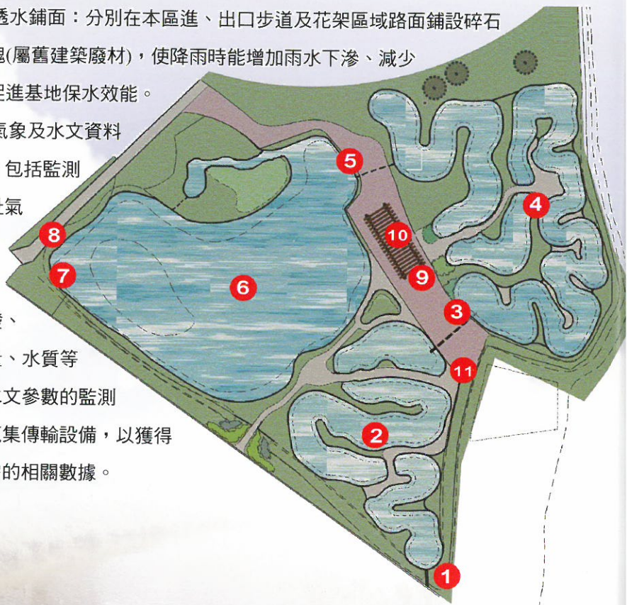
圖3 本校人工濕地系統的平面圖，1：污水進流口，2：表面下流動(SSF)濕地，3：SSF濕地出流口，4：表面流動(FWS)濕地，5：FWS濕地出流口，6：景觀生態池，7：生態池出流口，8：水回收再利用高壓幫浦及管線，9：太陽能光電設施，10：休憩花架，11：氣象及水文監測站，淺紫色區域則為透水鋪面鋪設範圍。
