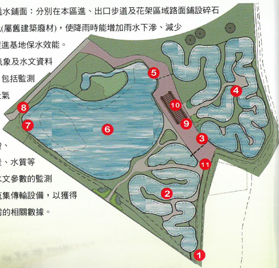
圖3 本校人工濕地系統的平面圖，1：污水進流口，2：表面下流動(SSF)濕地，3：SSF濕地出口，4：表面流動(FWS)濕地，5：FWS濕地出口，6：景觀生態池，7：生態池出口，8：水回收再利用高壓幫浦及管線，9：太陽能光電設施，10：休憩花架，11：氣象及水文監測站，淺紫色區域則為透水鋪面鋪設範圍。
