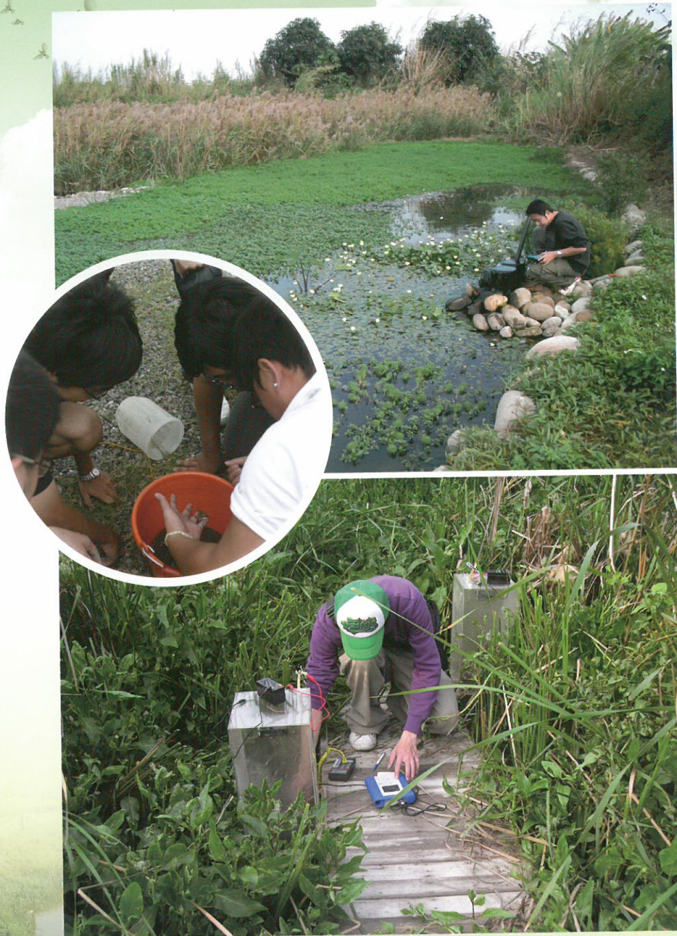
圖27 研究生在人工濕地內監測水質(上)、計量底棲昆蟲(中)及量測溫室氣體的產生(下)。
